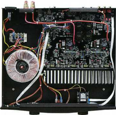
■内部：大型のトロイダルコア電源トランスを搭載。デュアルモノの回路は1枚基板上にまとめられる。
